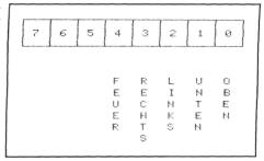
Das Datenregister A der CIAs ist zuständig für die-Joystick-Anschlüsse.
